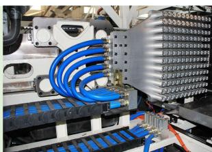
■ 宝捷HPET高速瓶坯注塑系统是为 适应大批量瓶坯生产需要而专门研 发,具备高速、精准、稳定可靠和 节能的四大优点,配套的模具采用 全热流道针阀式结构和科学的冷却 水道设计,是具有极高性价比的瓶 坯整体解决方案。
